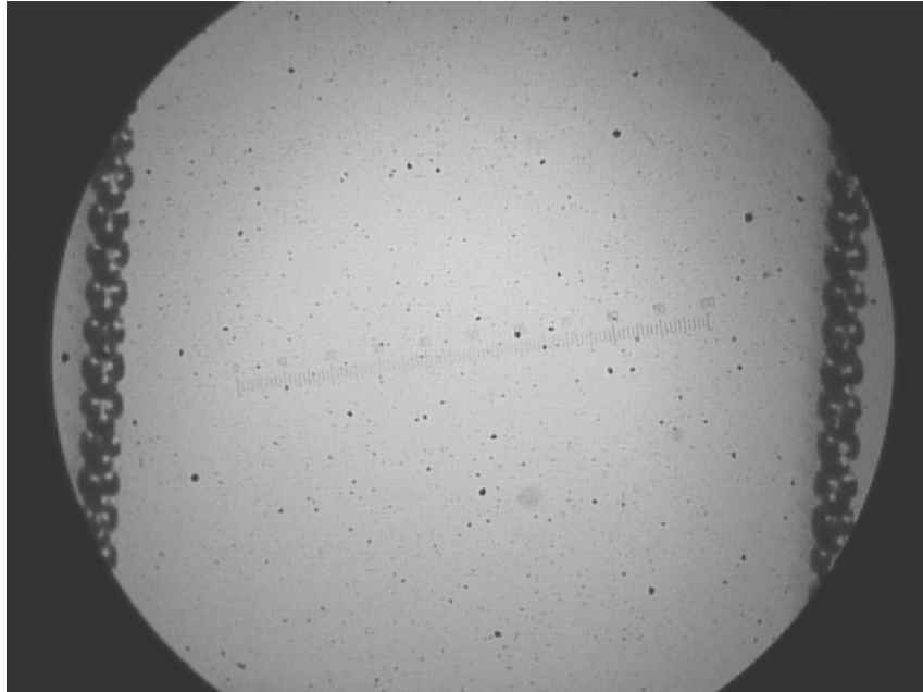
Figur 4. Et eksempel på en olieprøve svarende til renhedsklasse -/19/12 efter ISO 4406. Der er 3000 my mellem de to streger.
